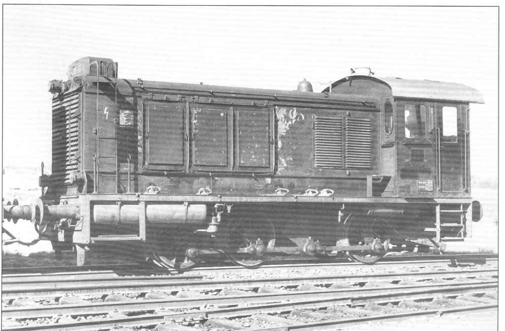
Mitte: V 36 004 mit der charakteristischen Anordnung des Hauptluftbehälter an der Führerhausrückseite nach Achslagerschaden abgestellt in Bruchhausen-Vilsen, 16. 7. 1983, Foto: Wolfram Bäumer
