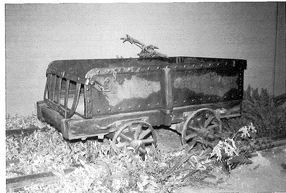
Unten: Güterwagen der Peak Forest Tramway mit abnehmbarem Aufsatz (für gröberes Schüttgut) auf einer fast zugewachsenen Winkelschiene, beide im National Railway Museum York. Foto: Uwe Nufbaum
