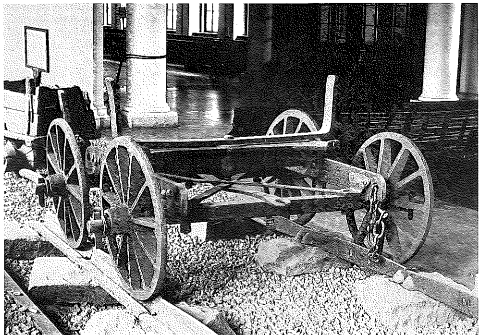
Unten: Wagengestell aus Guß- und Schmiedeeisen mit Drehschemel der Bahn Merthyr-Tydfil - Aberdare, gebaut um 1800 im Museum für Verkehr und Technik Berlin
