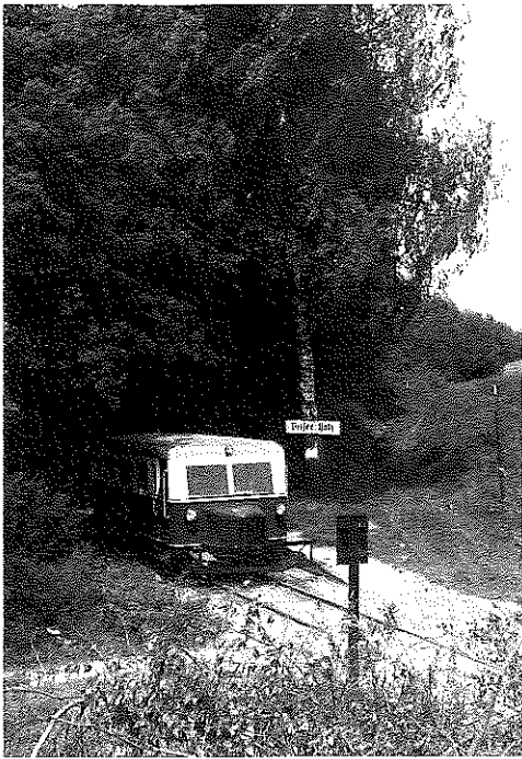
Bild links: Von Anfang an wurde beim DEV darauf geachtet, daß möglichst Fahrzeuge norddeutscher Kleinbahnen in das Beschaffungsprogramm aufgenommen wurden. Ein ganz typischer Vertreter dieser Gattung ist der Wismarer Schienenbus, der konstruktiv in Zusammenarbeit mit dem Landeskleinbahnamt Hannover entstand. Hp Vilser Holz, Mai 1971. Foto: Gerd Schrammen
