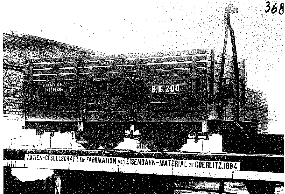
Am 4. Oktober 1894 erhielt der O 200 der Bromberger Kreisbahnen seine Abnahmeuntersuchung bei der Waggonfabrik. Er ist ein typischer Lenzscher Vielzweckwagen, abgebildet ist er als Hochbordwagen für Heutransporte, nach Abnehmen der eingesteckten Lattengestelle kann man den Wagen als normalen O-Wagen nutzen. Schließlich können alle Bordwände mit Ausnahme der Stirnwand abgenommen werden, dann handelt es sich um einen Flachwagen. Oberhalb des Bremsgewichtes hängt das Kettenglied, in das der Hebel zum Verbleib in Lösestellung eingehängt werden kann. Unter dem Wagenkasten, oberhalb des Wortes „zu“ erkennt man die Nachstellvorrichtung. Rechte Seite: Aus einem Prospekt von 1898 rekonstruierte Zeichnung der Görlitzer Gewichtsbremse. Fig. 1, 2 und 3 zeigen die Bauausführung mit Gewicht an einer Stange, Fig. 4, 5 und 6 die Anordnung mit Gewicht auf einem Hebel. Fig. 7 stellt die Nachstellvorrichtung und Fig. 8 die Haspel dar.
