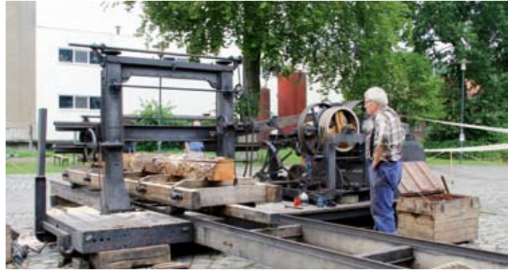
Auf dem Parkplatz war ein mobiles Sägewerk aus Holland aufgebaut und es wurden unermüdlich Balken und Bretter gesägt.
