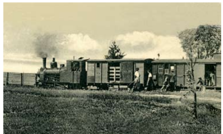
In die Haltestelle Swainen (J.K.B.-Strecke Insterburg - Skaisgirren) ist um 1910 der Zug 30 nach Insterburg eingefahren. Hinter der Lok der Lenz-Gattung m läuft der mit einem „Großviehgitter“ ausgestattete Wagen 158 (Baujahr 1906). Foto: Slg. Kleinbahnmuseum.
