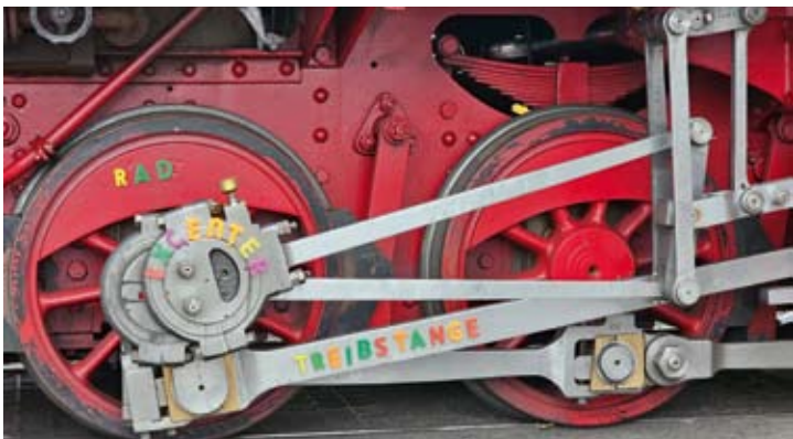
Mithilfe von Magnetbuchstaben wurden die zum Teil schwierigen Bezeichnungen von Lokbauteilen wie hier an der Allan-Steuerung von Dampflok HERMANN benannt und konnten so Kindern einprägsam erläutert werden.
