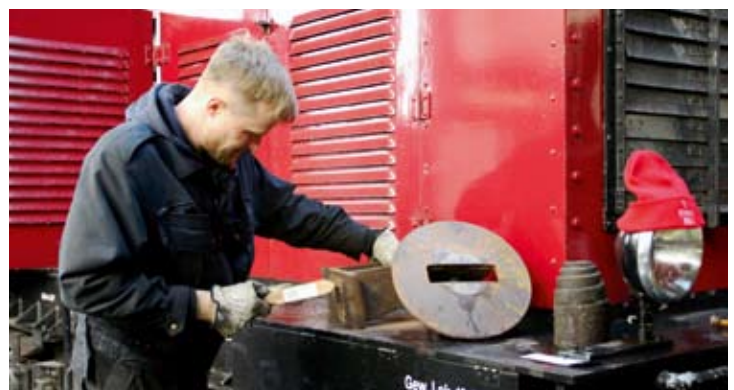
Nach Abschluss der Rangierarbeiten kam V4 „Emden“ auf die Grube. Im Rahmen der HU wurde die Zug- und Stoßvorrichtung erneuert, hier Peter Kempf beim Entrosten. 18.02.23, alle Fotos: RM
