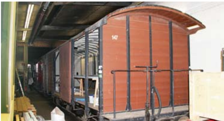
Aus dem Wagen 16 heraus ein Blick auf den in Restaurierung befindlichen Wagen 147. Die Seitenwände werden neu verbrettert. 05.02.23
