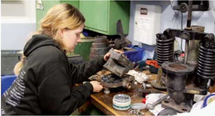
Auf der Werkbank des „Bierverlages“ war das Sicherheitsventil der HOYA in Arbeit und Hannah Lange reinigte das Steuerventil der Bremsanlage des Rollwagens 178. 18.02.23
