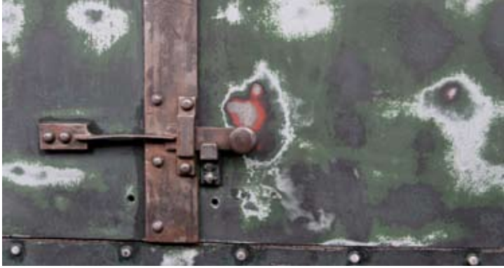
Nach technischer Aufarbeitung mußte Lok 3" vorbereitet werden für den neuen Lack, hier ein Detail vom Anschleifen der Front. 18.03.23
