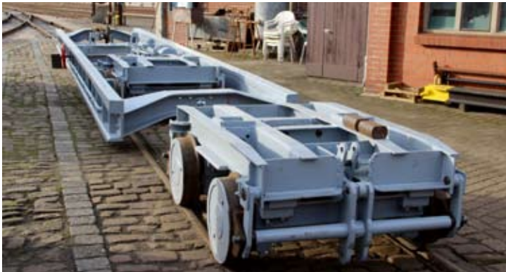
Bei strahlendem Sonnenschein konnten ein Fahrwerk und der Rahmen des Rollwagens 178 unter dem Kran kurz vor der endgültigen Montage fotografiert werden. 17.03.23
