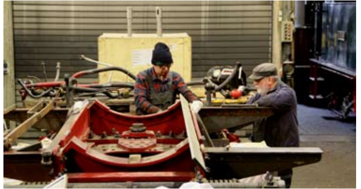
Hinter dem Rolltor der Fahrzeughalle waren Thomas Meyer und Bernhard Schulze bei der Montage der Bedienhebel für die Zylinderentwässerung der Mallet. 16.03.23
