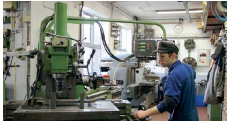
In der „Drehbankbude“ hatte Jannik Westermann Teile der Balancierkuppelung von Wagen 7 eingespannt zum präzisen Bohren. 04.02.23
