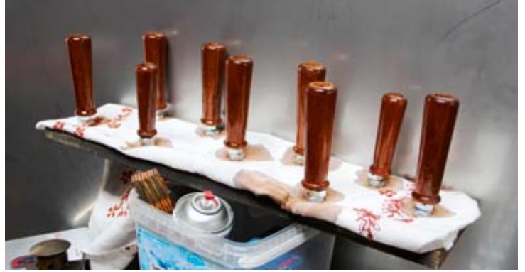
Neu angefertigt wurden die hölzernen Handgriffe für die Dampfmatrinen, die wirken hier beim Trocknen des Lacks fast wie eine „Serienproduktion“. 18.03.23
