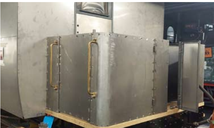
Ansicht von außen: Bei der Kleinbahn Leer-Aurich-Wittmund besaß der Wagen ursprünglich keine Übergangstüren. Daher werden diese optisch so dezent wie möglich gehalten.
