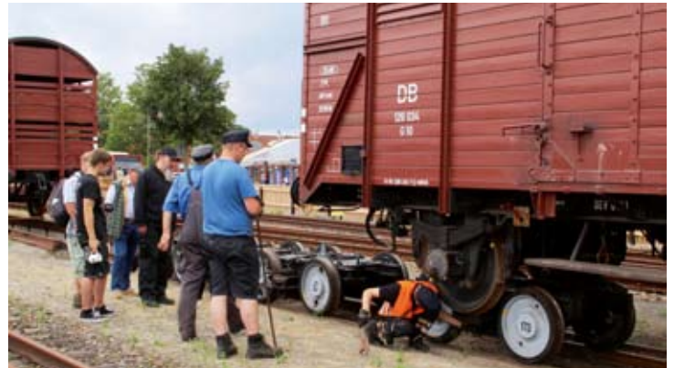
Probelauf für die Tage des Eisenbahnfreundes: Das Auf- und Abbocken des DEV-Normalspurgüterwagens Gw 1 auf Rollböcke wird von Robert Angerhausen erklärt. Bruchhausen-Vilsen, 5. August 2022.
