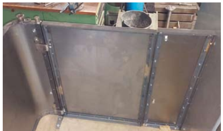
Bereits montierte Bühnen-Eingangstür von Wagen Nr. 7: Die Bühnengeländer und Türen werden komplett neu gefertigt. Bruchhausen-Vilsen, 6. November 2022. Zwei Fotos: Ralf Hormann
