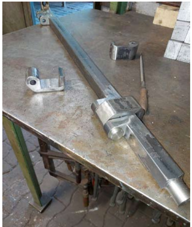
Türzarge mit Scharnieren einer der neu angefertigten Bühnentüren von Buffetwagen Nr. 7 vor der Montage. Bruchhausen-Vilsen, 6. November 2022. Foto: Ralf Hormann
