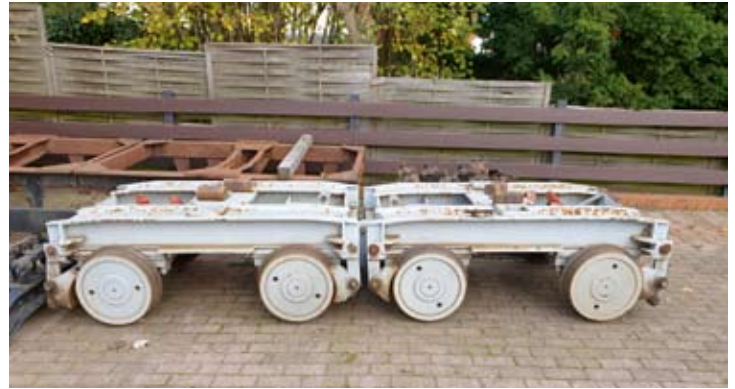
Die Drehgestelle von Rollwagen Nr. 178 mit ihren Unterflur-Drehzapfen, an die der Rahmen untergehängt wird. Bruchhausen-Vilsen, 28.10.2022. Foto: Uwe Franz
