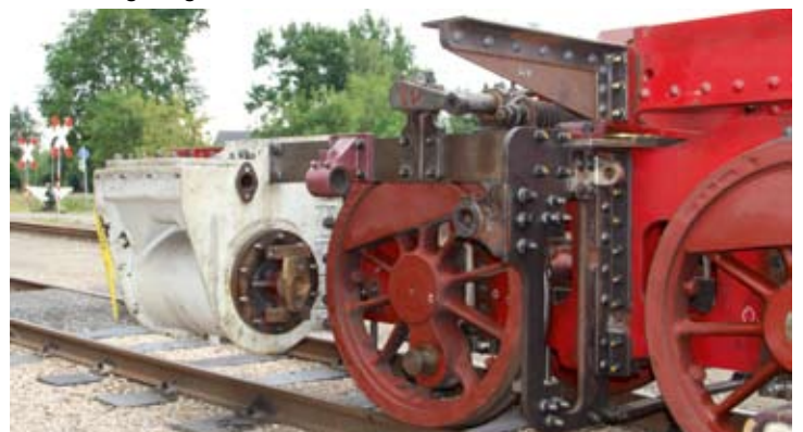
Alle Halterungen, Schraub- und Nietverbindungen müssen exakt eingepasst sein, damit später alles präzise funktioniert. Bruchhausen-Vilsen, 1. Juli 2022. Alle Fotos: RM
