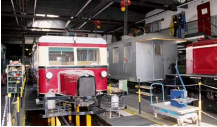
Blick in die DEV-Werkstatt am 30. Juni 2022: Links der in Motorreparatur befindliche Triebwagen T 41, rechts der neu verblechte „Silberling“ Büffetwagen Nr. 7.
