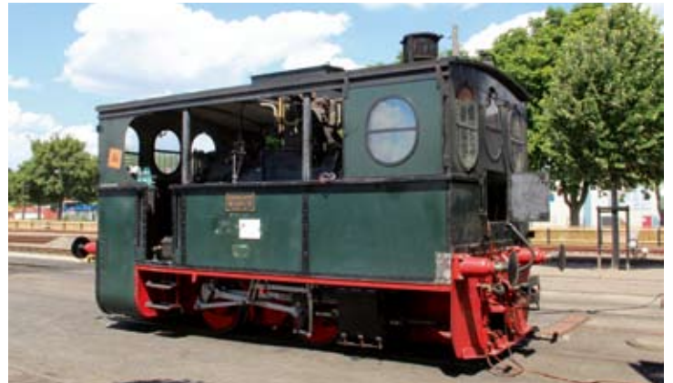
Die Hauptuntersuchung an Dampflok PLETTENBERG schreitet voran, die seitenversetzten Normalspurpuffer fürs Rangieren im Dreischienengleis sind montiert. Bruchhausen-Vilsen, 3. Juli 2022.
