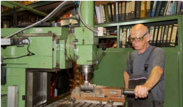
Thomas Meyer beim Ausfräsen von Lagern der Mallet-Lok 7s. Bruchhausen-Vilsen, 30. Juni 2022.
