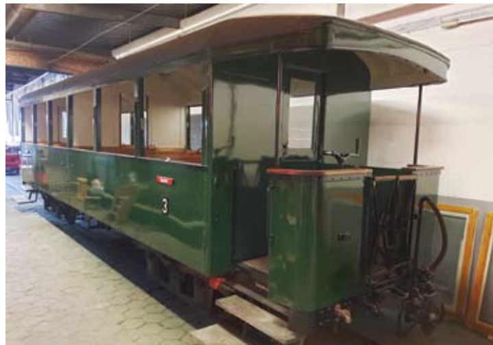
Wagen 12 frisch lackiert mit neuer, faltenfreier Dachhaut, aber noch ohne Seitenfenster.
