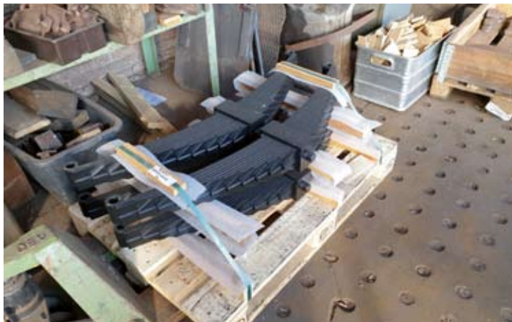
Die neuen Radsatzfedern für Wagen 7 sind eingetroffen und können eingebaut werden.
