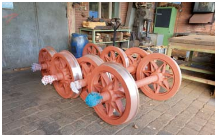
Die aufgearbeiteten Speichenradsätze für Wagen 7 stehen für die weitere Bearbeitung bereit. Bruchhausen-Vilsen, 18. März 2022. Alle Fotos: Uwe Franz
