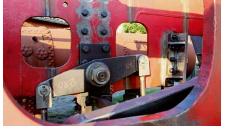
Zu den zahlreichen passgenau aufzuarbeitenden bzw. anzufertigenden Bauteilen gehören die Ausgleichshebel für die Federung. Bruchhausen-Vilsen, 5. September 2021. Foto: RM
