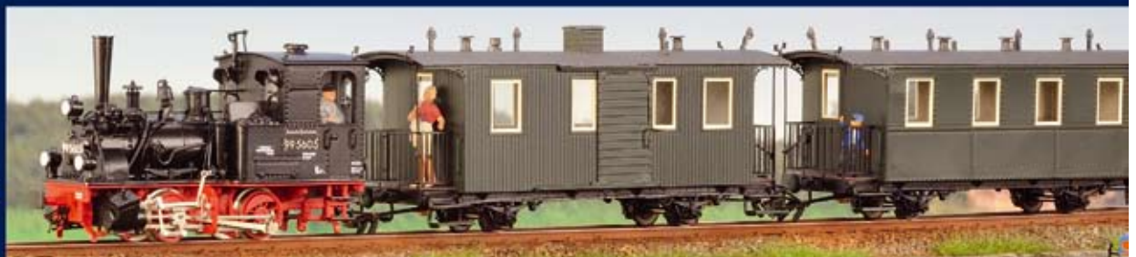
Testweise erhielt die Dampflok PLETTENBERG ihre asymmetrisch angeordneten Normalspurpuffer zurück. Bruchhausen-Vilsen, März 2021. Foto: Lars Böcker
