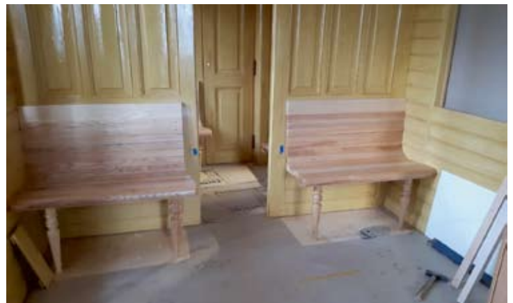
Die ersten Sitzbänke sind im restaurierten Wagenkasten montiert. Zwönitz, 14. Januar 2021. Zwei Fotos: Veikko Hübner
