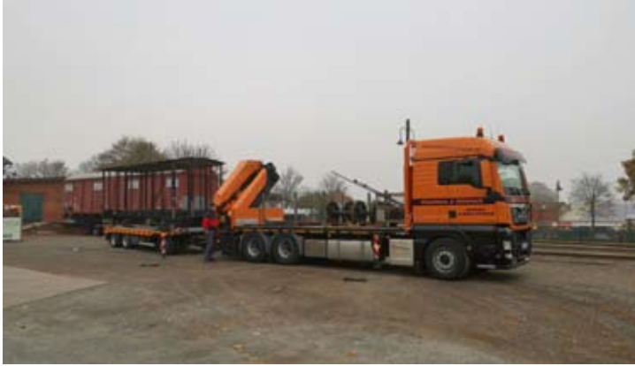
Der entbretterte und ausgeachte Güterwagen 129 auf dem Weg zum Sandstrahler per Tieflader. Bruchhausen-Vilsen, 10. November 2020. Foto: Lars Böcker
