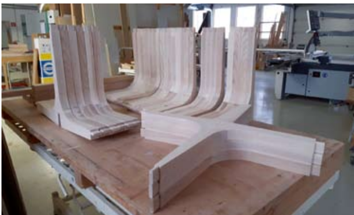
Die neuen Holzrahmen für die 3.-Klasse-Sitzbänke von Wagen 7 sind bei der Tischlerei Hübner in Zwönitz in Arbeit.
