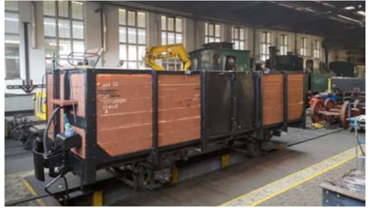
Die Verbretterung von Güterwagen 112 wurde in der Werkstatt angeschliffen und kann neu lackiert werden. Bruchhausen-Vilsen, 16. November 2020. Foto: Lars Böcker
