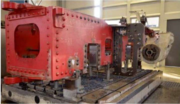
Vorderes Triebgestell der Mallet auf dem Bohrwerk: Die Achslagerführungen und andere Bauteile können passgenau ausgefräst und gebohrt werden. Leubsdorf, 15. September 2020, Foto: Thomas Meyer
