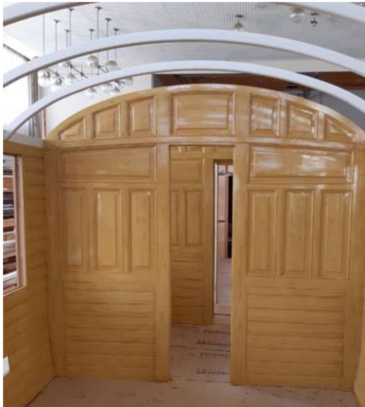
Am 12. August 2020 waren auch Bierlasur und Klarlack im 3. Klasse-Abteil bereits aufgetragen. Foto: Veikko Hübner
