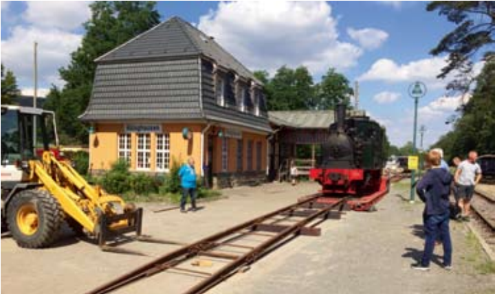
Abladung der SPREEWALD vom Straßentiefnader mittels Rampe bei der Ankunft in Hüinghausen. 21. Juli 2020, Foto: Benjamin Riedesel
