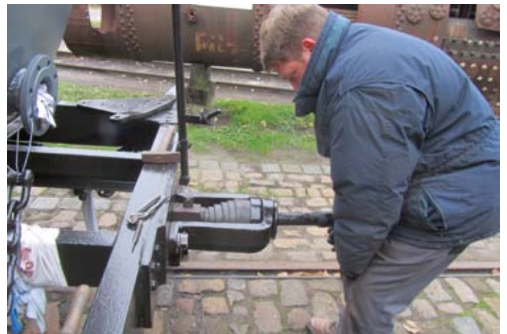
Torben Kleist beim Montieren eines Puffers am neu lackierten Kesselwagen Nr. 152 auf dem Gleis neben der Werkstatt. 24. November 2019, Foto: Christian Uhle
