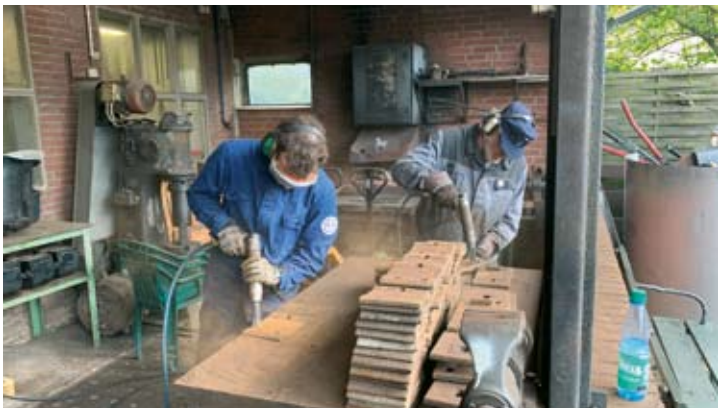
Die Kleiseisen sind noch gut erhalten, müssen aber von Richard Wilkening und Robert Angerhausen mit dem Druckluftnadrler von Rostanhaftungen befreit werden. Bruchhausen-Vilsen, 9. Okt. 2019. Foto: Nils Böcker
