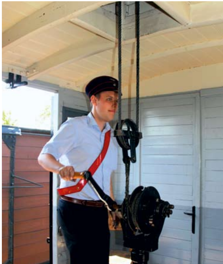
Zugführer Simon Keller bremst den Zug vom Gepäckwagen 31 aus mit der Haspel und den Seilzügen der Görlitzer Gewichtshebelbremse.
