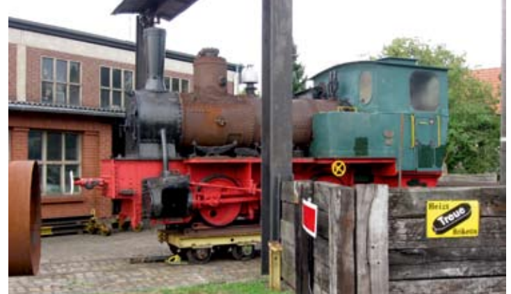
An Denkmaldampfloks JAN REINERS wurden mittlerweile die völlig korrodierten Kesselbleche abgenommen, so dass sich der Kessel derzeit recht nackt zeigt. Bruchhausen-Vilsen, 1. August.2019, Foto: DM
