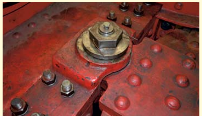
Das fertig montierte Hauptgelenk zwischen Vorder- und Hinterwagen.
