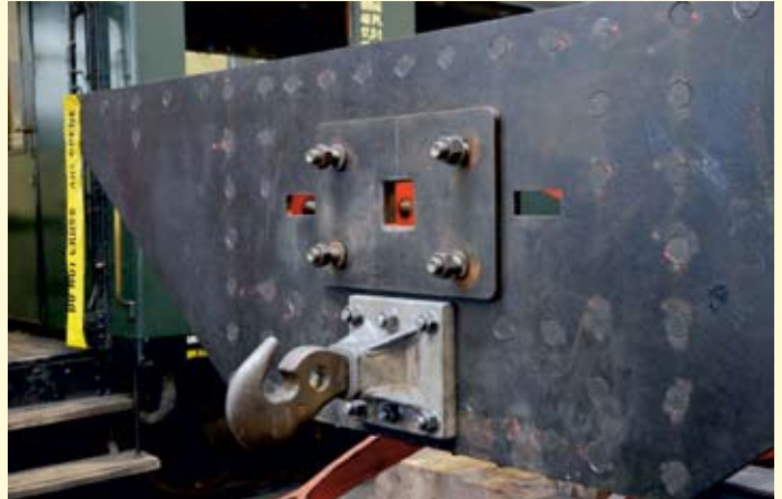
Die hintere Pufferbohle mit Mittelpuffer, Balancierkupplung und Lenz-Unterpufferkupplung.
