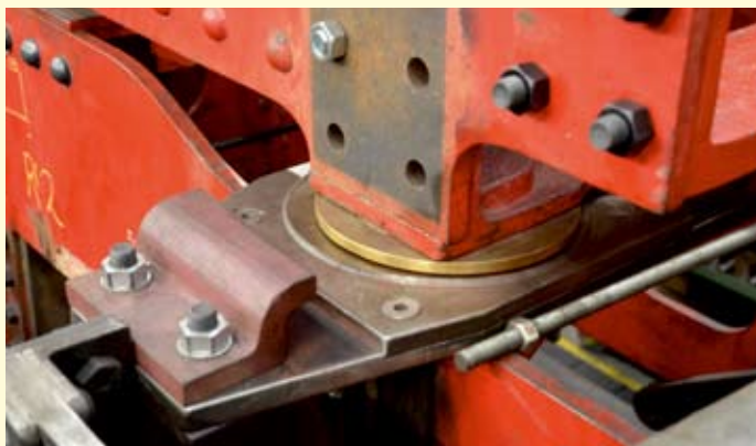
Abstützung des Hinter- auf dem gelenkig angeordneten Vorderwagen der Malletlok 7 s .
