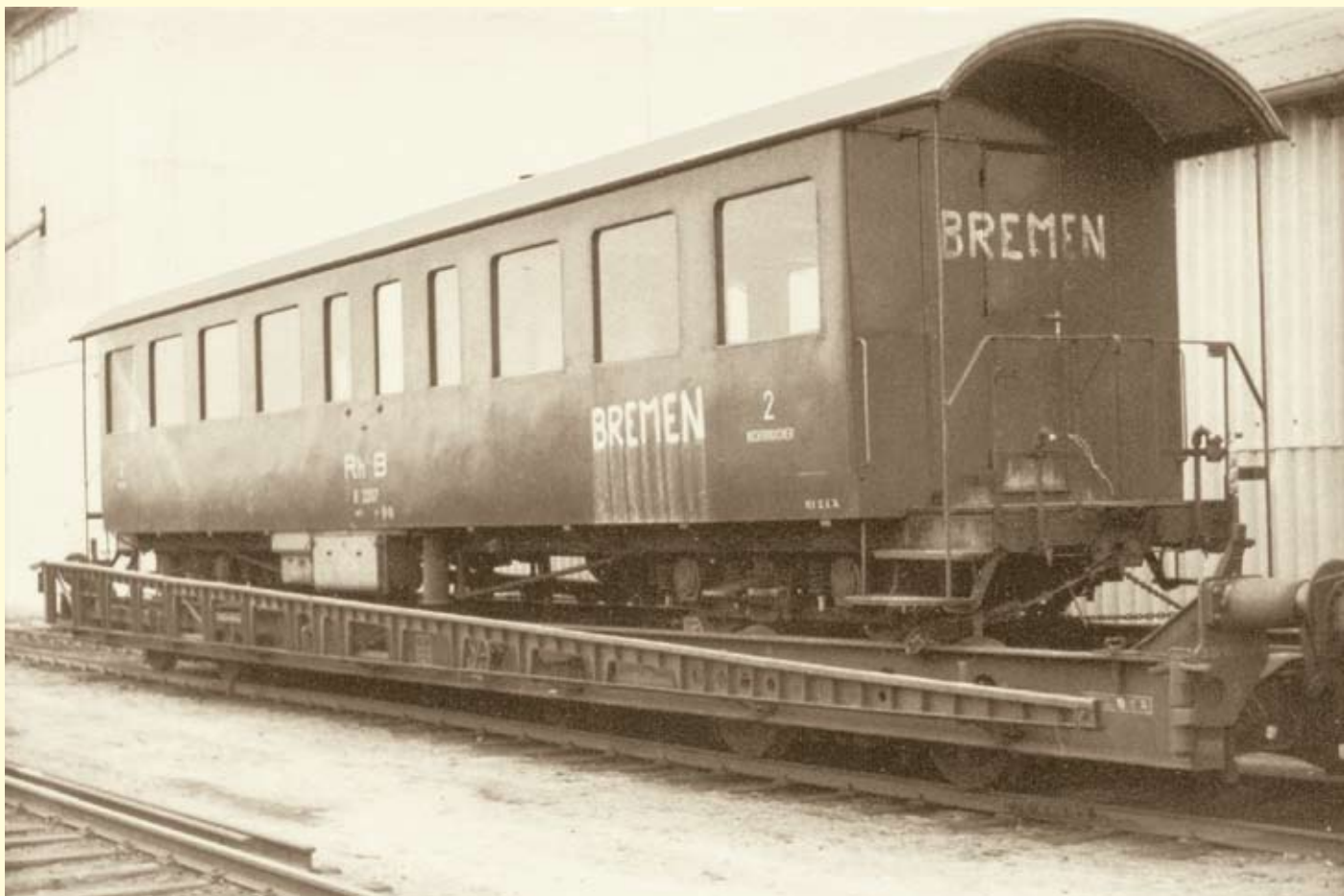
Der damals „neue“ Büffetwagen Nr. 15 bei der Ankunft in Bruchhausen-Vilsen 1977, noch im RhB-Outfit. Standesgemäß wurde der Wagen damals noch per Bahn überführt. Der Transportwagen führte sogar die nötigen Verladerampen mit sich. Foto Slg. Hans-Jürgen Wietig
