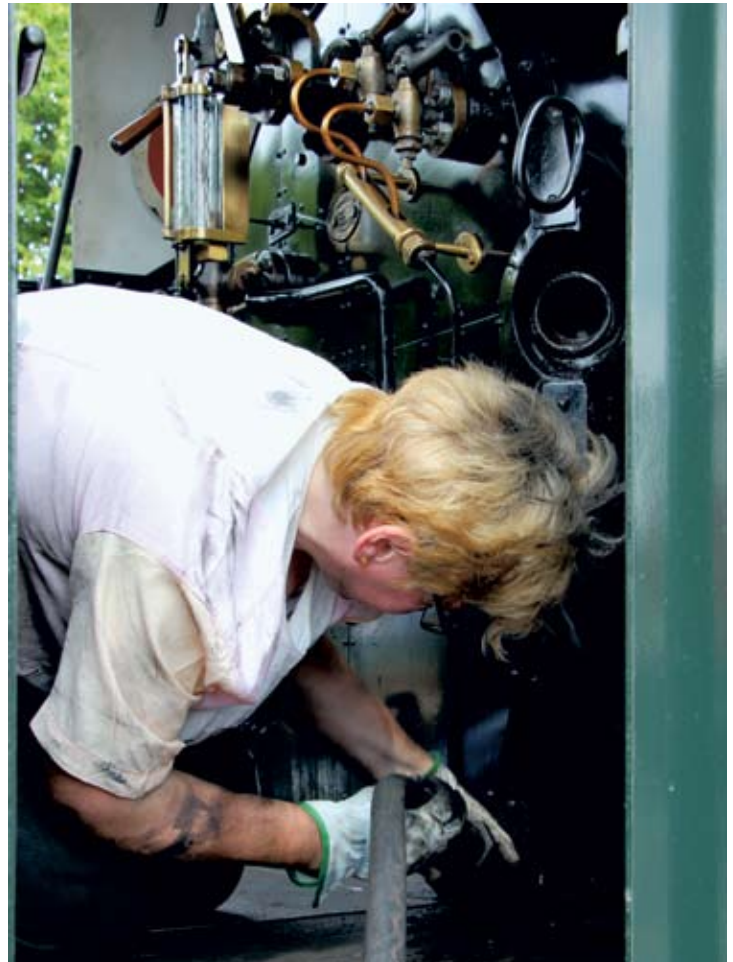
Beatrix Bessling-Seemann beim Kessel-Auswaschen der HOYA im unteren Teil.
