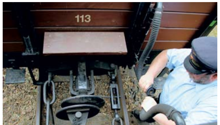
Rangieren in Heiligenberg: Schaffner Frank Bechmann hat einen Güterwagen angekuppelt und verbindet noch die Schläuche der Saugluftbremse miteinander. 19. Mai 2018. Vier Fotos: RM
