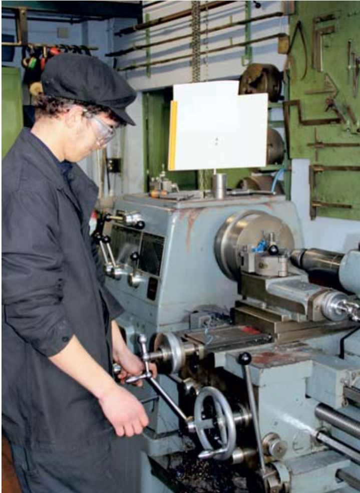
An der Drehbank fertigte DEV-Youngster Elias Okrongli einen Bolzen nach Zeichnung an – Handarbeit mit Fingerspitzengefühl.
