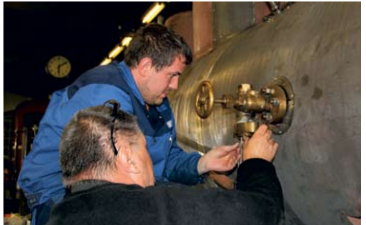
Noch kein „Feierabend“: An der HOYA bauten Wolfgang und Stephan Moll die Armaturen an – Messingteile nach Maß.
