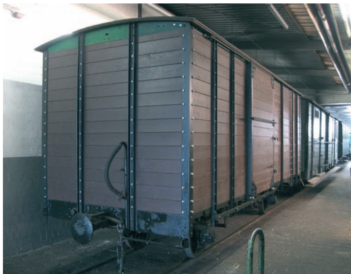
Mit großen Schritten geht der nun verbretterte Gepäckwagen Nr. 51 seiner Fertigstellung entgegen. Bruchhausen-Vilsen, 2. Juli 2016, Foto: Dennis Mellerowitz
